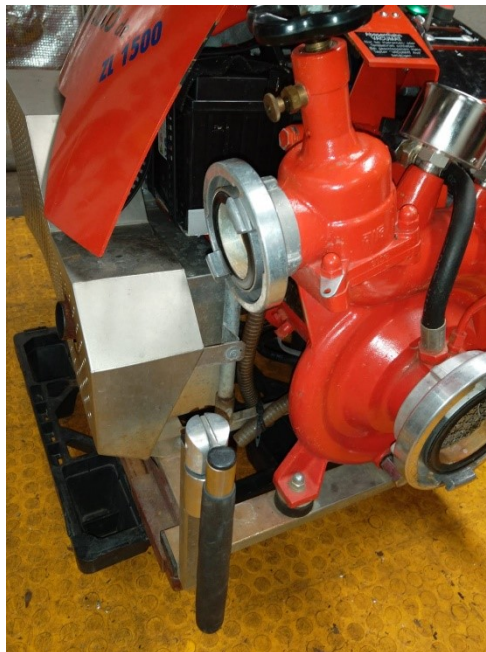
Darstellung Pumpenausgang / Abgangsutzen B-Schlauch:
